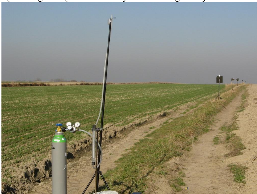
Rys. 2. Układ dozowania SF 6 do powietrza i punkty recepcyjne
